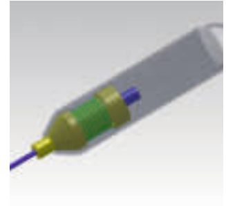
Ab 500 – 5000 g Zinkendruck arbeitet die Zugfeder
