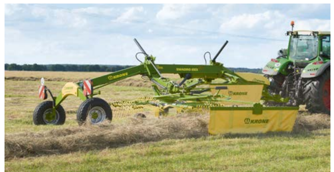
Zweikreiseln-Seitenschwader Swadro TS und TS Twin Arbeitsbreiten von 6,20 m bis 8,20 m
