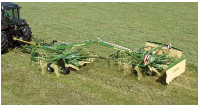
Zweikreiseln-Seitenschwader Swadro 710/26 T Arbeitsbreite 6,20 m oder 2 x 3,40 m
