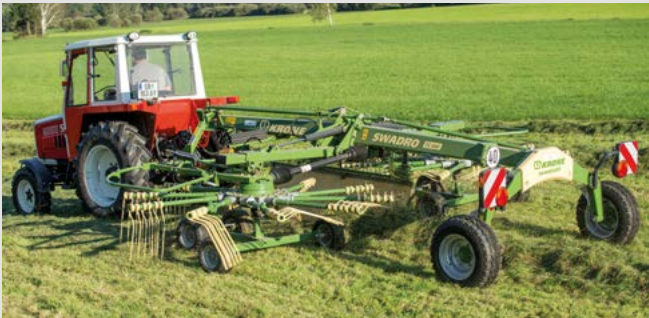
Swadro TC 640 und Swadro TC 680 Arbeitsbreite: 5,70 m – 6,40 m und 6,80 m
