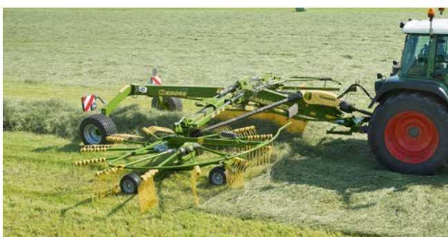
Zweikreiseln-Mittelschwader Swadro TC und TC Plus Variable Arbeitsbreiten von 5,70 m bis 10,00 m
