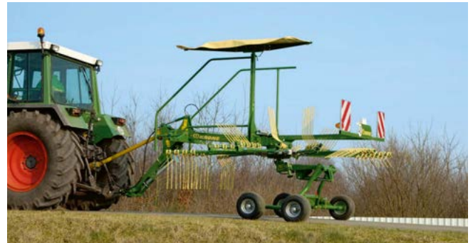
Einkreiselschwader Swadro, gezogen Arbeitsbreiten von 3,80 m bis 4,60 m
