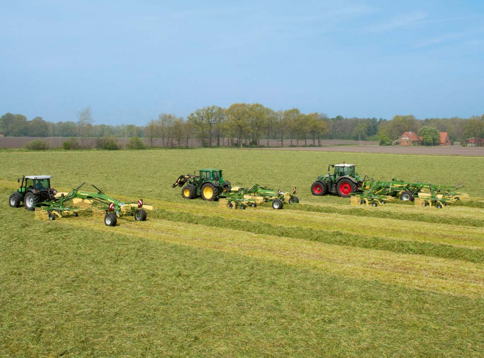
Vierkreisel-Mittelschwader Swadro TC 1370 Variable Arbeitsbreiten von 10,80 m bis 13,70 m
