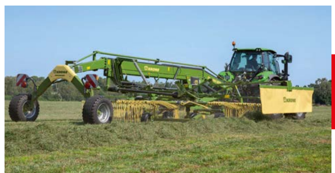
Dreikreiseln-Seitenschwader Swadro TS 970 Arbeitsbreite 9,70 m
