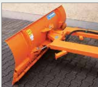
Abb. „Typ C“ mit hydraulischer Schwenkeinrichtung
